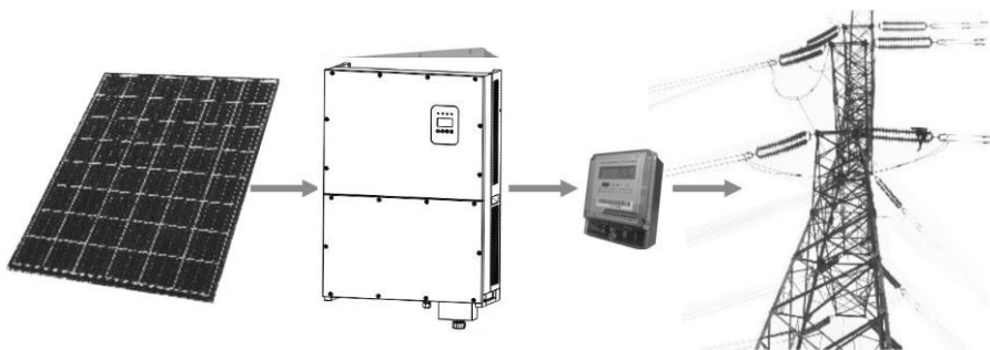
Hình 1: Ứng dụng của máy biến tần kết nối lưới điện năng lượng mặt trời trong hệ thống phát điện năng lượng mặt trời.
